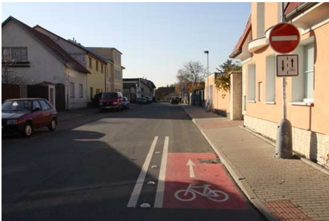
ilustrační foto: Zóna 30 s obousměrným provozem cyklistů – cykloobousměrky jsou vodorovným značením (VDZ) vyznačeny pouze na začátku a konci, jinak je provoz společný.
