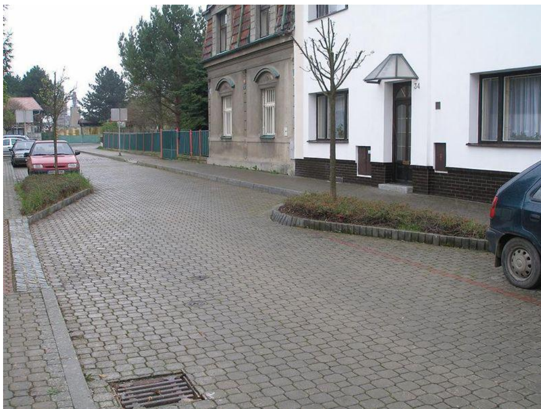
Obrázek 30. Střídavé oboustranné zúžení (šikana) v Praze-Satalicích. Zdroj: http://cs.wikipedia.org/
