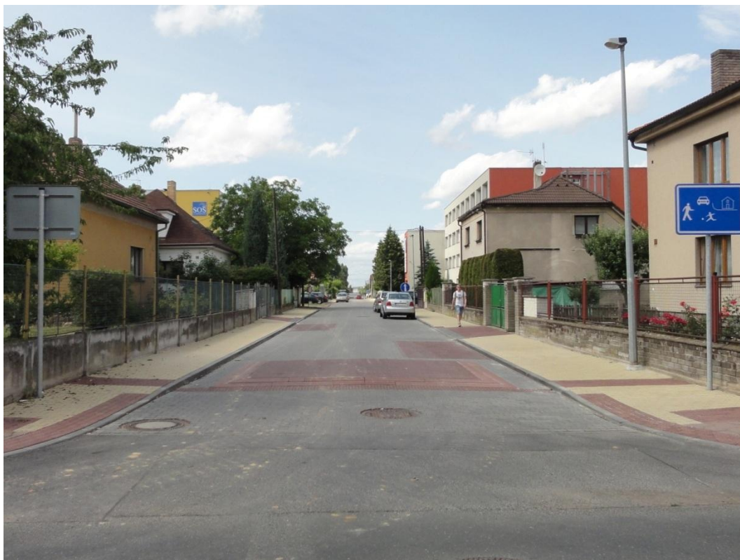
Obrázek 29. Zpomalovací polštář v ulici Lipí. Zdroj: autor
