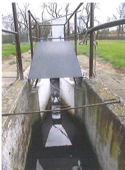
Obr. 7 Měrný profil MP3 - Umístění sondy US 1200 nad Parshallovým žlabem
