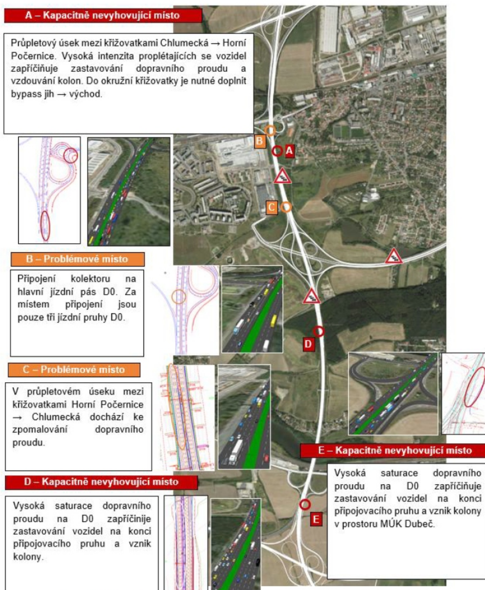
Obrázek 48 – Označení problémových a nevyhovujících míst z dynamické mikrosimulace
