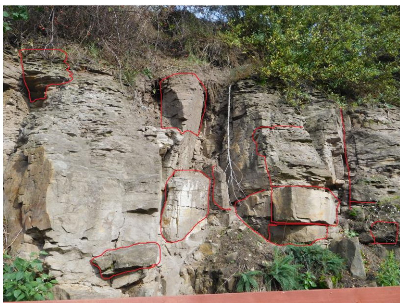
Foto č. 3: horninové bloky postihnuté překlápěním, naznačení směru a sklonu diskontinuit nejkritičtějších částí masivu
