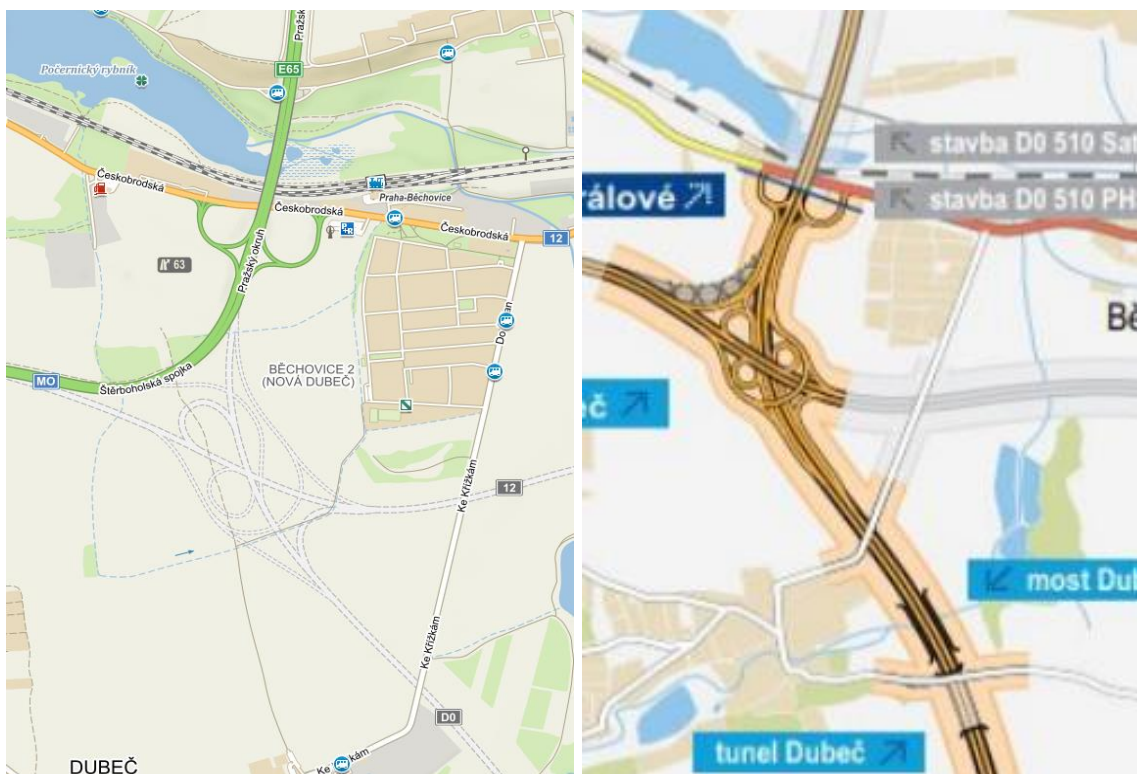
Výřez z mapy s umístěním MÚK Dubeč a MÚK Českobrodská („brýle“) spolu s napojením na most přes Počernický rybník – vlevo stávající stav, vpravo znázorněno napojení na SOKP 510
